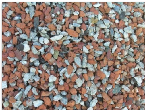
Ανακυκλωμένα κοκκώδη αδρανή υλικά. Πηγή: ANPAR
