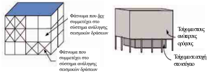
Σχ. Σ5.1 Παραδείγματα μη-κανονικότητας καθύψος: Διακοπή φορέα καθύψος (αριστερά), εκτός επιπέδου εσοχή (δεξιά)
